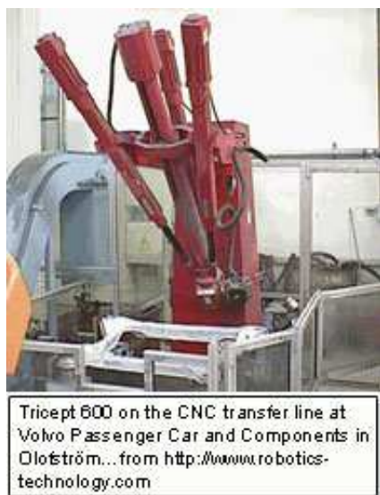
Figura 1 – Neos Tricept (Neumann, 1988). Trata-se de uma estrutura tetrapode que contém um elemento central passivo para restringir a movimentação de rotação espacial da base.
