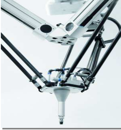
Figura 2 – O robô Delta, desenvolvido por Clavel (1990). Se trata de um mecanismo com 4 DOF baseado em conectores pantográficos.
