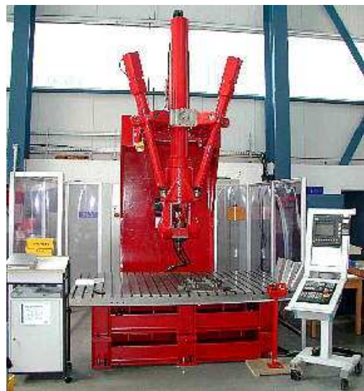
Figura 1 – Neos Tricept (Neumann, 1988). Trata-se de uma estrutura tetrapode que contém um elemento central passivo para restringir a movimentação de rotação espacial da base.
