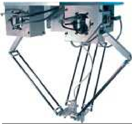
Figura 3 – O robô H4, desenvolvido por Pierrot (1998). Possui uma arquitetura similar ao do Delta, mas emprega membros topologicamente simétricos.
